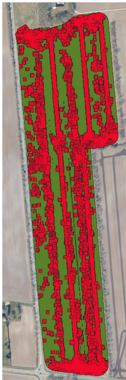
Foto 3 Mark 63-0, beregnede behandlingsområder (rød) efter overkørsel med PerPlant kamera med 3 m. bufferzoner. 19/09-24. PerPlant.
